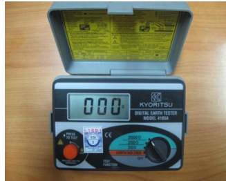
Đồng hồ đo tiếp địa Đo điện trở tiếp địa, điện trở đất
